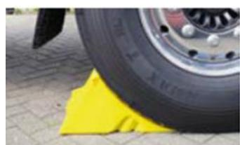
Tekerlek takozlarını tekerleklerin önüne/arkasına mümkün olan yuvarlanma yönünde yerleştirin.
